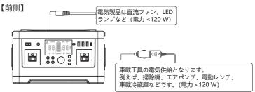
※ 本機の DC 直流出力電圧の範囲は 9 V~12.6 V で、最大出力電流は 12 A です。電池が化 学品であるため、DC 電圧は電池容量の低下とともに低下します。もし接続された DC 12 V の電気製品に充電安定機能が付いていないと、入力電圧が低すぎて製品は自動的に オフにします。この時、接続するデバイスを解除し、本機を充電してください。
